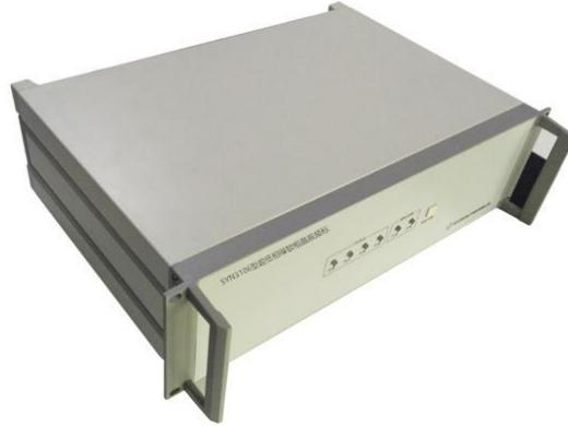
该锁相晶振频标提供三种不同场合应用：1 独立使用作为频标基准；2 锁相到外部铯钟保持高准确度，净化降低铯钟相位噪声；3 锁相到外部氢钟，保持高稳定度，净化降低氢钟的远端相位噪声。
